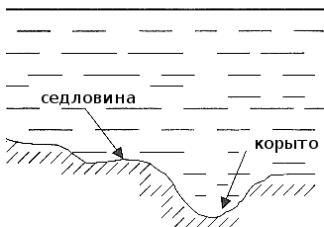
Рис. 4. Перекат, поперечный разрез.
