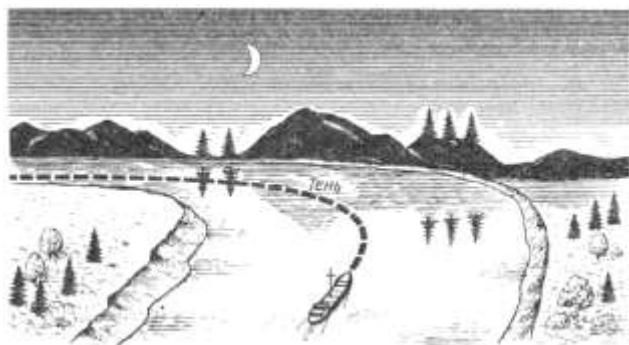
Рис. 64. Схема входа судна в тень от береговой возвышенности в ночное время
