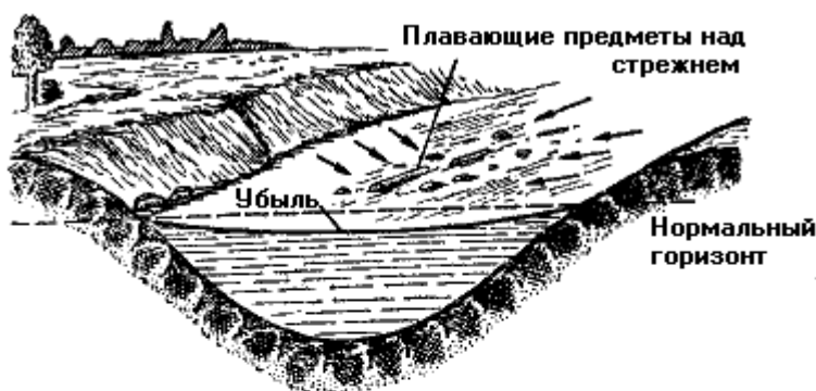
Рис. 65. Схема живого течения при убыли и при резкой прибыли воды
